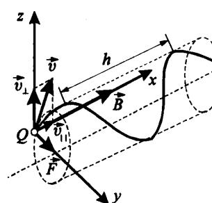
Суммарное движение будет движением по спирали, ось которой параллельна магнитному полю. Шаг винтовой линии  $h = v_{\parallel} T = vT \cos \alpha$ , где
