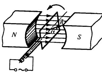
Пусть рамка вращается равномерно с угловой скоростью  $\omega = \text{const}$ . Магнитный момент, сцепленный с рамкой площадью  $S$ , в любой момент времени  $t$  равен
