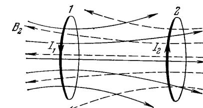
от друга. При протекании в контуре 1 тока  $I_1$  магнитный поток пронизывает второй контур:
